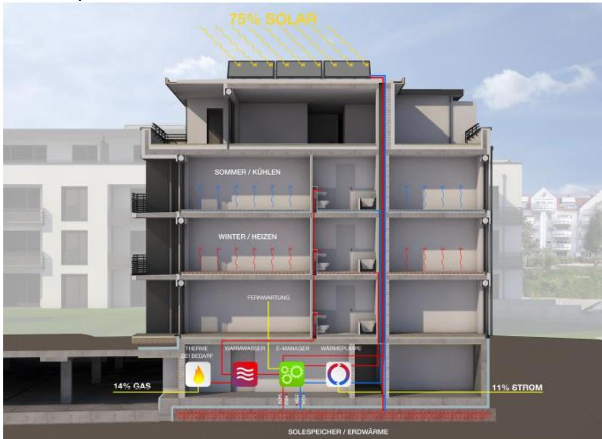
**Die Heiz-, Kühl- und Warmwasserenergie wird über verschiedene Medien generiert und diese sind mit einem intelligenten EnergieRoutingSystem (E-Manager) verbunden:**
